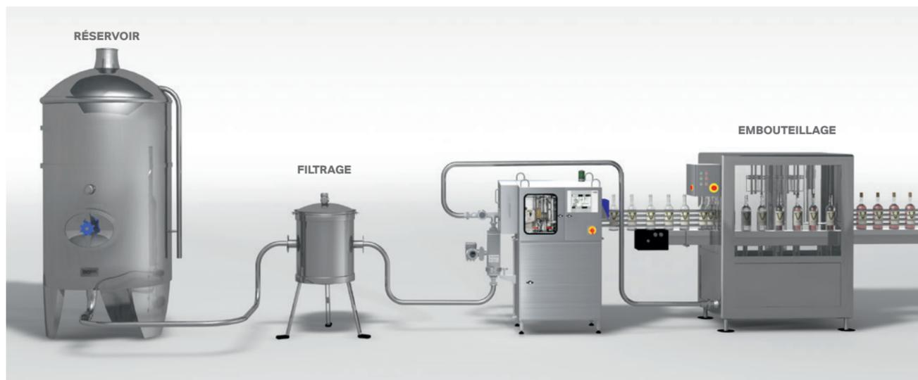
La pompe de dosage Velcorin® est intégrée aux chaînes d'embouteillage nouvelles ou existantes. Elle peut être utilisée pour le passage d'un réservoir à un autre ou avant le remplissage de conteneurs. Les modifications à apporter à une chaîne d'embouteillage déjà existante sont minimales.
